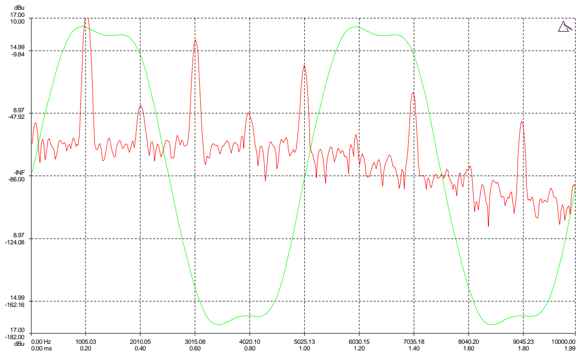
Abb. 3.1a Systemantwort bei 7V Eingangsspannung
