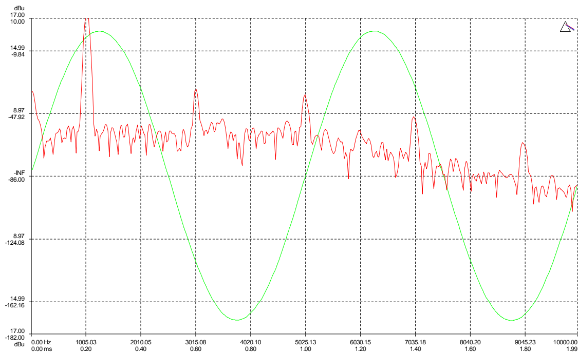
Abb. 3.1b Systemantwort bei 5,1V Eingangsspannung
